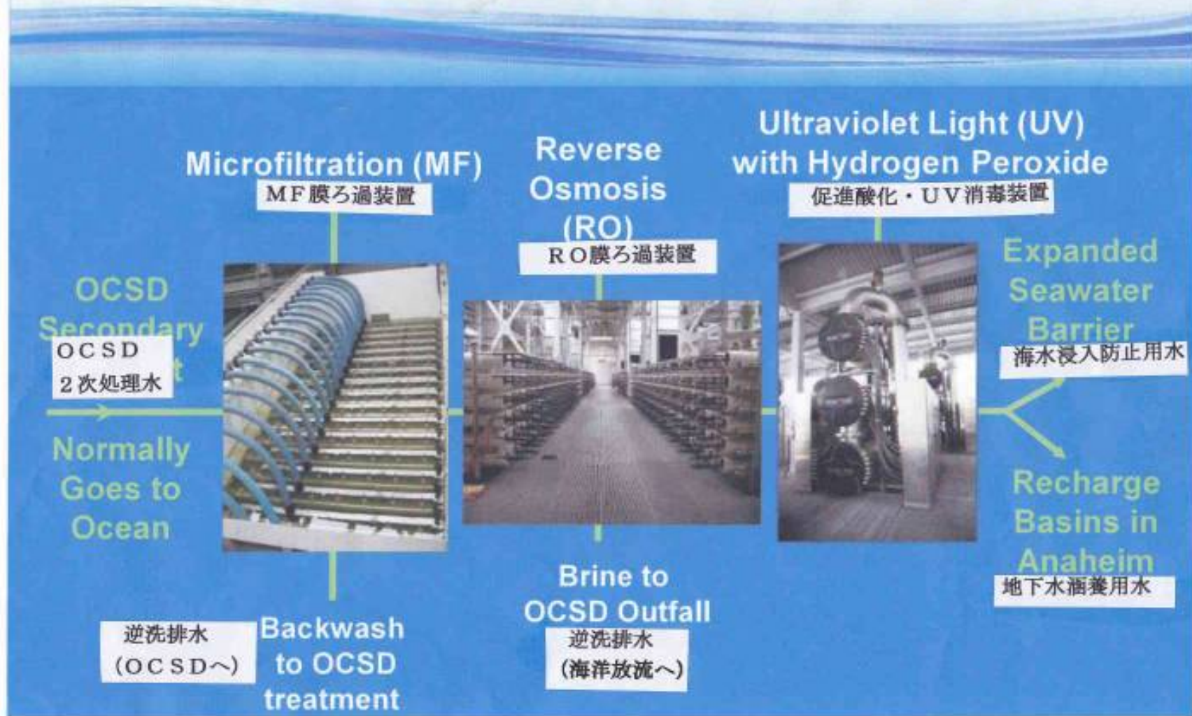
図-20: OCWDの高度処理施設 (MF膜、RO膜、UV・H2O2消毒法)
