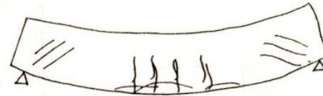
(b 4 ) コンクリート部材など最大曲げモーメント部の下縁のはく離と亀裂、支点附近の引張力による亀裂
